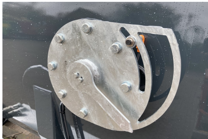
Tankmåler, stopper automatisk fyldning.
