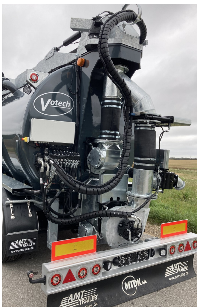
Alu-lygtebom med integreret underkørselssikring.
