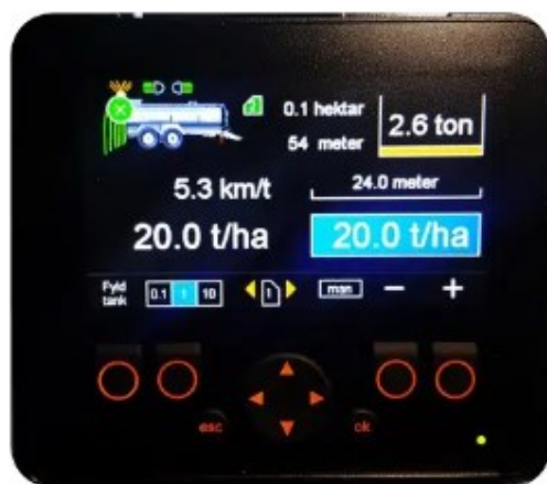
VP-Controller, kørselsafhængig dosering.
