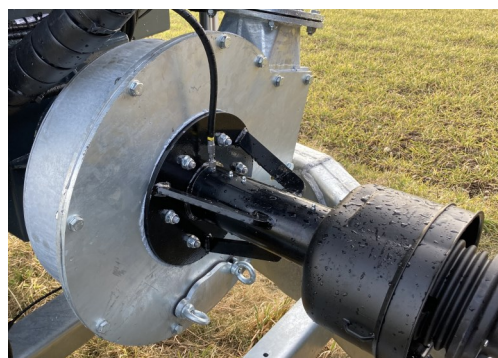
Aflæsse kapacitet op til 18.000l/min, pumpehus fremstillet i HARDOX.
