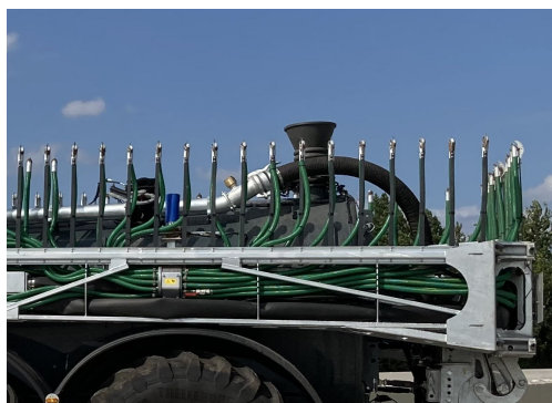
Ekstern fyldetragt 10", rotorblink giver signal ved fuldtank.
