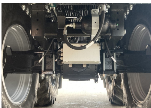
Hjultræk bruger traktorens hydraulik. Differentiale aksel, sikre minimal vedligehold.
