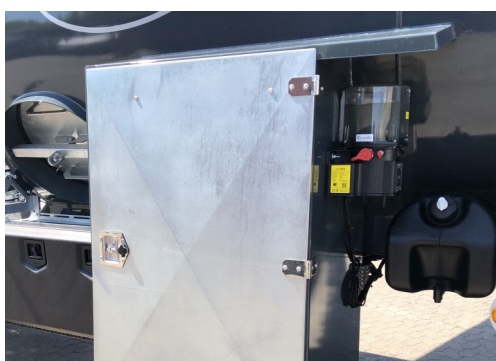
Nem fyldning af centralsmøring uden brug af stige.
