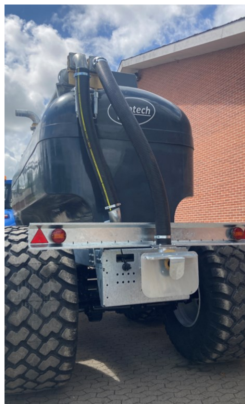
Lygtebom, superspreder og omrøring i tank.
