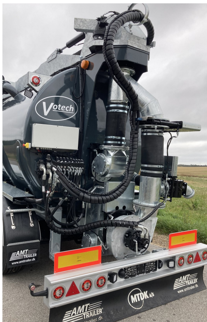
Alu-lygtebom med integreret underkørselssikring.
